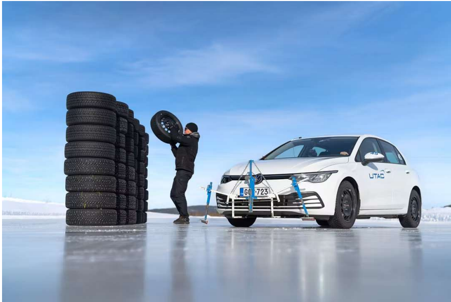
Minsta snökristall på isen påverkar greppet. Och vi vill ha samma grepp för varje däck. Därför har vi byggt en anordning som tar bort snökornen på isen. Det är den som sitter framtill på testbilen. Foto: Juha Kauppinen
