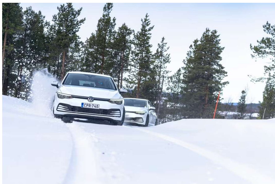
Visst ska däckerna klara spårig väg med nysnö. Men vi testar alltid på väl preparerade banor med samma underlag varv efter varv. En pistmaskin kör över banorna efter fyra däck och för att vara alldeles säkra på att det inte är underlaget som avgör testresultatet kör vi med referensdäck efter tre testdäck. Foto: Juha Kauppinen
